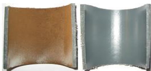
Abbildung 21 : Gesamtbild zum Vergleich vor und nach der Reinigung mit dem Aqua Protect System
