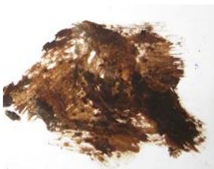
Abbildung 13: in Rohre befundenen schleimartigen Biofilm
