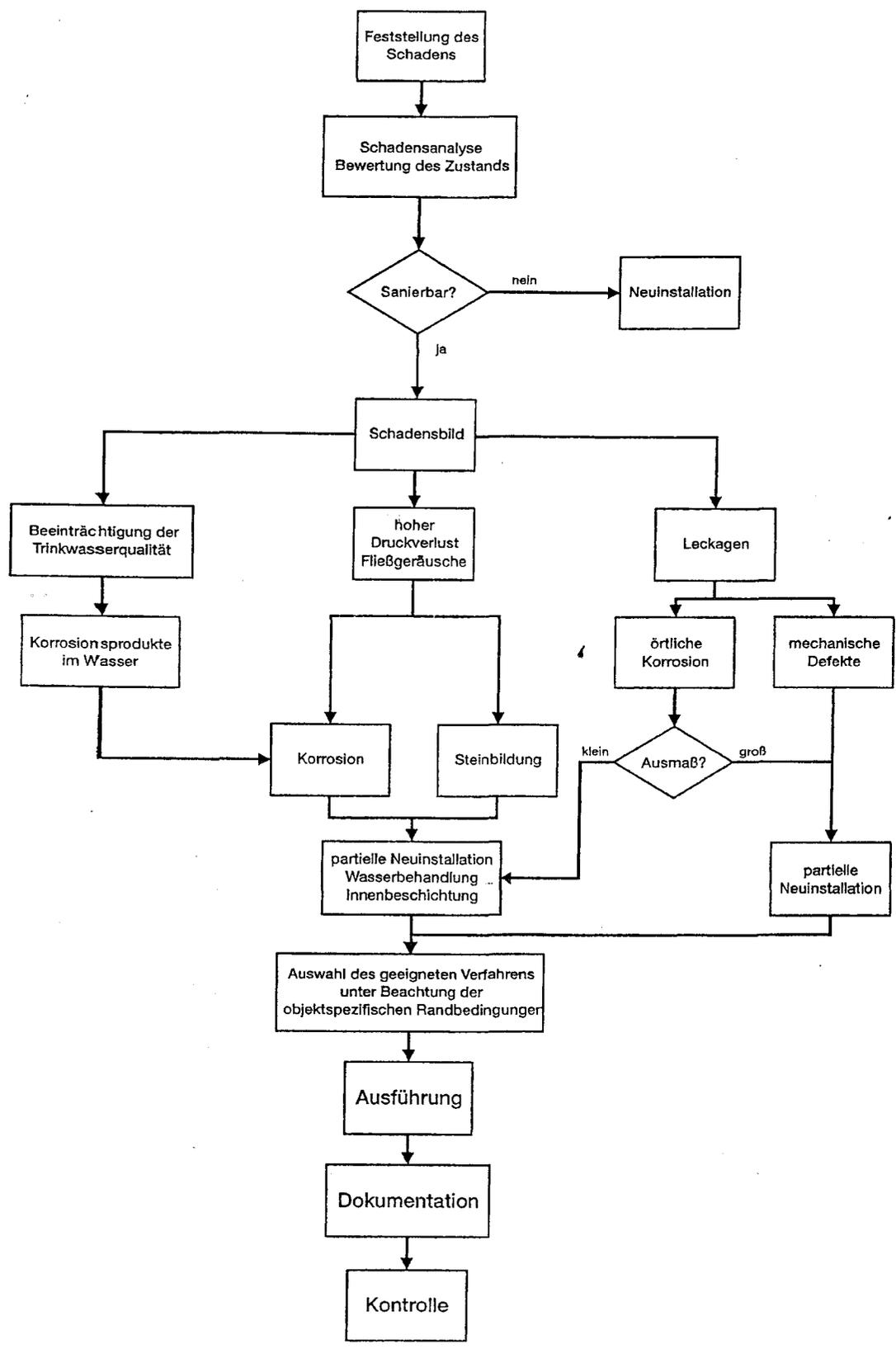
Bild 1. Schematischer Ablauf einer Sanierung
