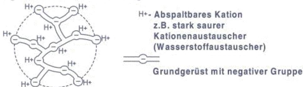
Das besprochene Grundgerüst ist in dieser Kugel (Bild I) vielfach und im gesamten Volumen vorhanden. Die im Austauscher aktiven Gruppen sind nicht nur auf der Kugeloberfläche, sondern befinden sich auch im Kugelvolumen. Eine einzelne Austauscherkugel hat somit viele Austauschergruppen, die befähigt sind, die im Wasser vorhandenen gelösten Salze auszutauschen
